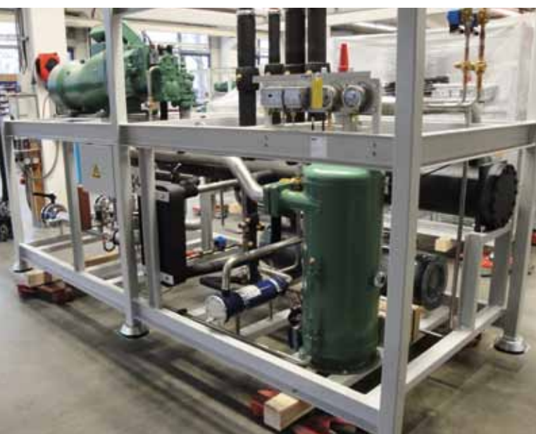
Kältemaschine mit Schraubenverdichter für eine Umweltsimulationsanlage
